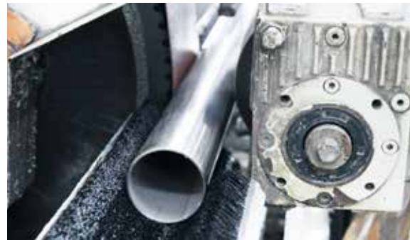
Lijado "Centerless" de tubos y barras.
