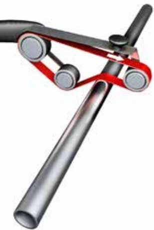
Rectificado redondo de tubos y barras Mojadora de control manual
