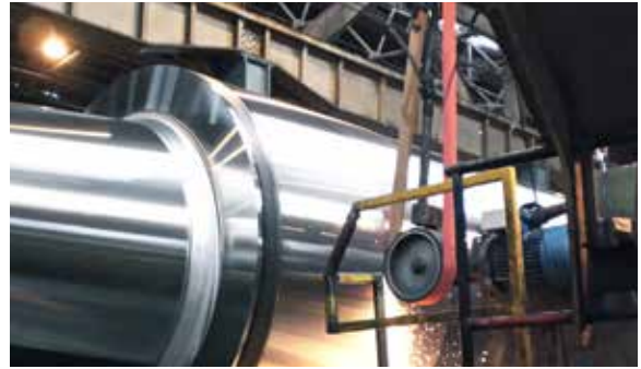
Esmerilado de rodillos en continuo
